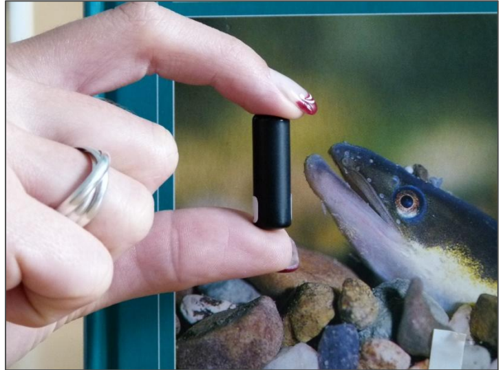
Bild 5: Solche hydroakustischen Sender wurden im Rahmen dieser Studie in die Bauchhöhle der Aale implantiert. Sie sind ca. 3 cm lang und wiegen etwa 9 g. Foto: IfF.
