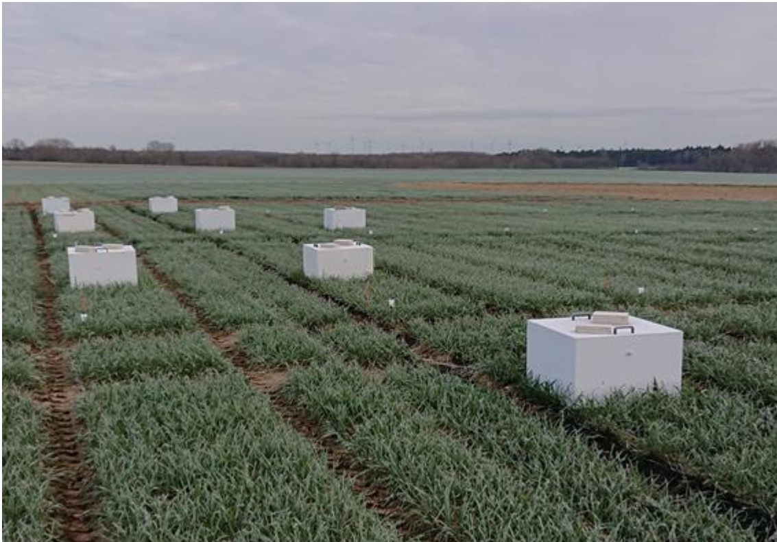
Abbildung 1: Messhauben der Emissionsmessung im Winterweizen im April 2023
