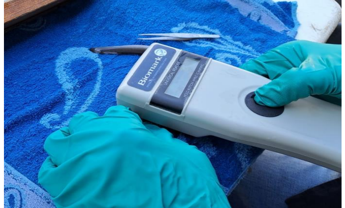
Bild 2: Vor dem Aussetzen werden die Aale individuell mit PIT-Tags markiert. Mittels aktiver Suche können diese passiven Sender wiedergefunden werden und erlauben so eine Schätzung des Fraßdrucks von Kormoranen auf den Aalbestand. Foto: IfF
