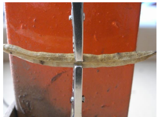
Abbildung 4: Versuchsstand zur Ermittlung der Platzfestigkeit und vorbereitete Rapsschote für die Messung
