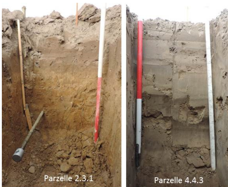
Abbildung 2: Beispiele unterschiedlicher Bodenprofile im Versuch: Parzelle 2.3.1 mit Lehmboden (links); Parzelle 4.4.3 mit reinem Sandprofil (rechts).
