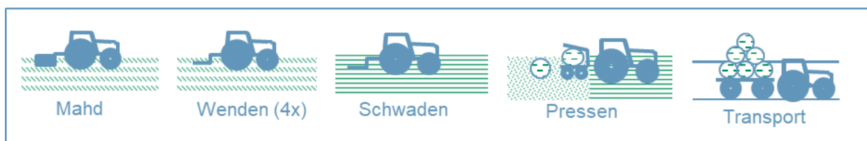
Abbildung 6 Verfahrensschritte der Heubereitstellung
