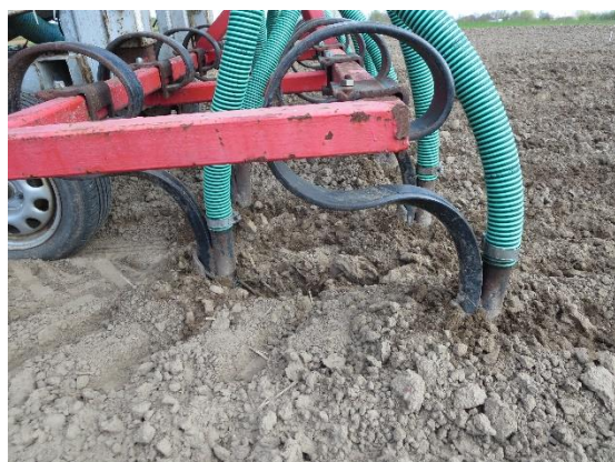
Abbildung 4: Güllegrubber für die Gärrestausbringung im Sommergetreide (Fotos Titze)
