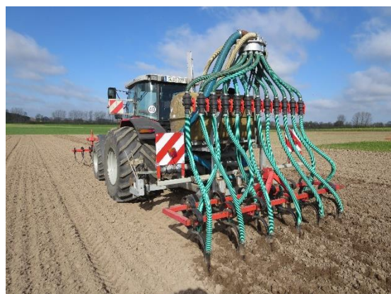
Abbildung 4: Güllegrubber für die Gärrestausbringung im Sommergetreide (Fotos Titze)
