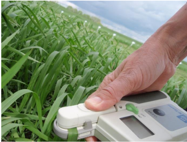
Abbildung 5: Messung mit Yara-N-Tester (Foto: Gruber)
