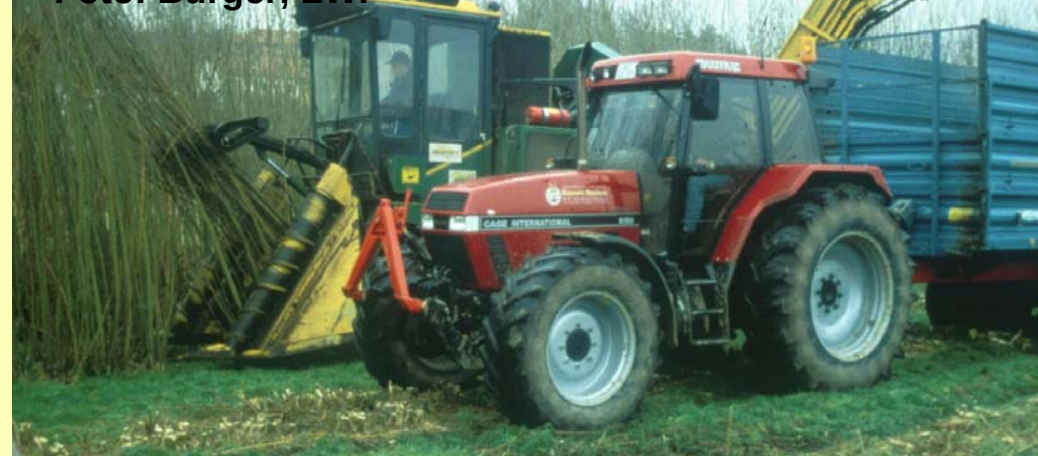
Modifizierter Zuckerrohrernter Austoft 7700 Foto: Burger, LWF
