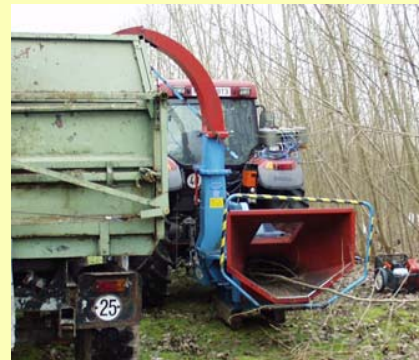
Schneckenhacker, Fa. Laimet Steigung: 110 mm (65 mm)
