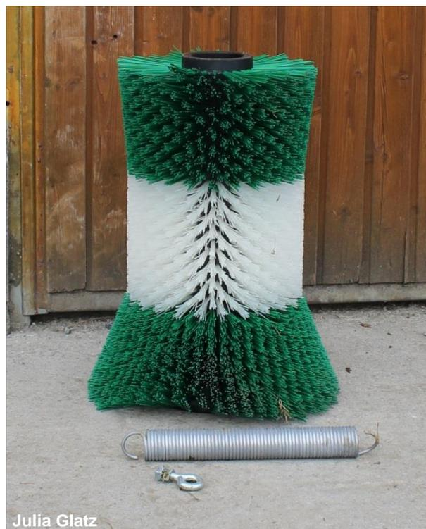
**Abb. 5: Bürsten und Federn müssen nach einigen Jahren erneuert werden**
