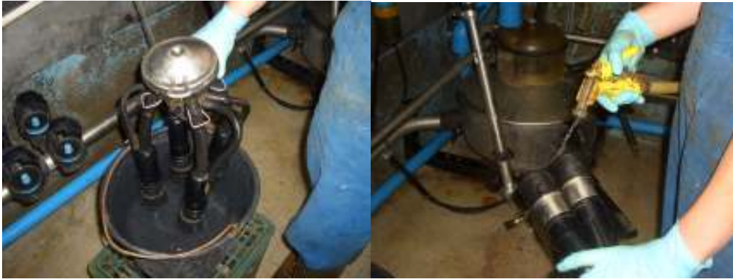
Abbildung 10: Zwei Beispiele für konventionelle Zwischendesinfektion des Melkzeugs. Links: manuelles Sprühverfahren, rechts Tauchverfahren.
