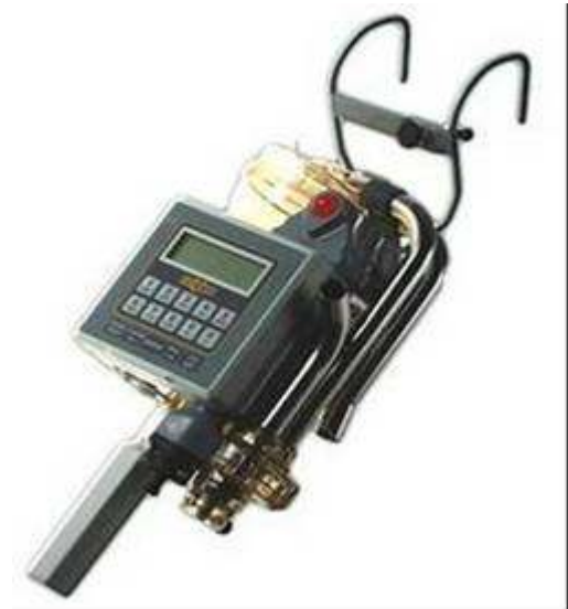
Abbildung 3: Vorwarte Hof mit Nachtreibehilfe Abbildung 4: Lactocordermessgerät
