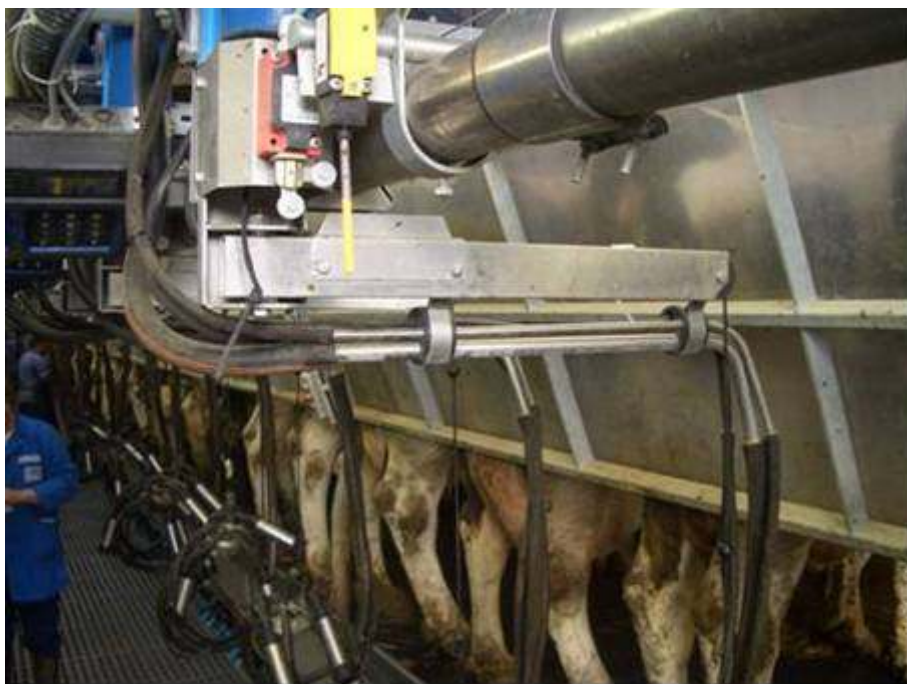
Abbildung 2: Der für Swing Over-Melkstände typische Schwenkarm
