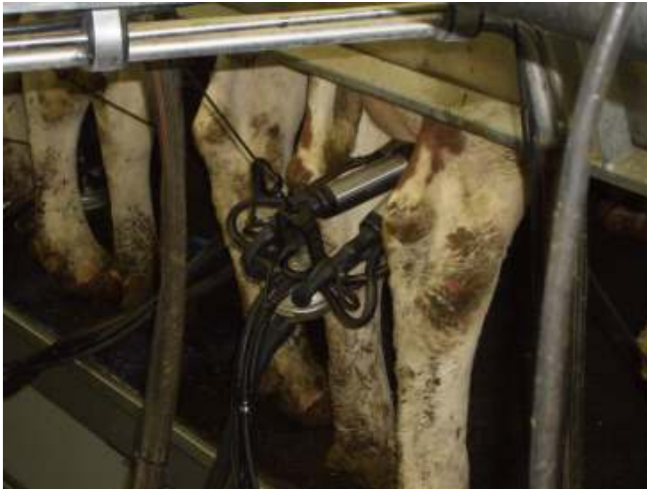
Abbildung 11: Beispiel für das Hängenbleiben des Melkzeuges nach Einsetzen der Abnahmeautomatik
