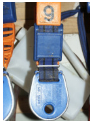
Foto 2. Beispiel eines Aktivitätssensors am Halsband activity sensor on the collar
