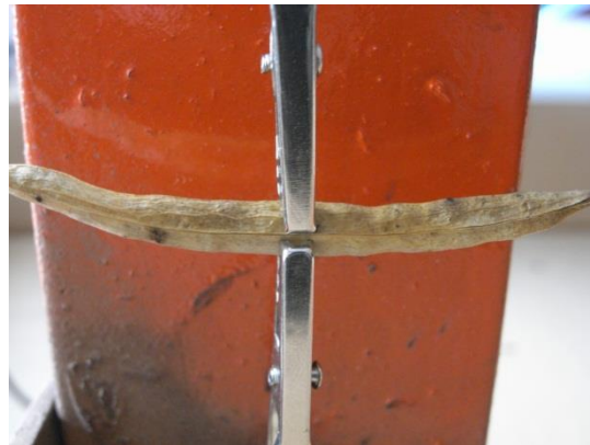
Bild 3: Versuchsstand zur Ermittlung der Platzfestigkeit und vorbereitete Rapsschote für die Messung
