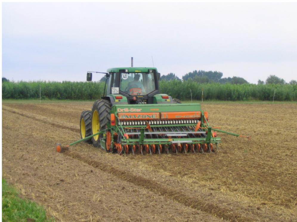
**Bild 1: Bestellkombination von Amazone KG-RP-AD 3 m Arbeitsbreite.**
