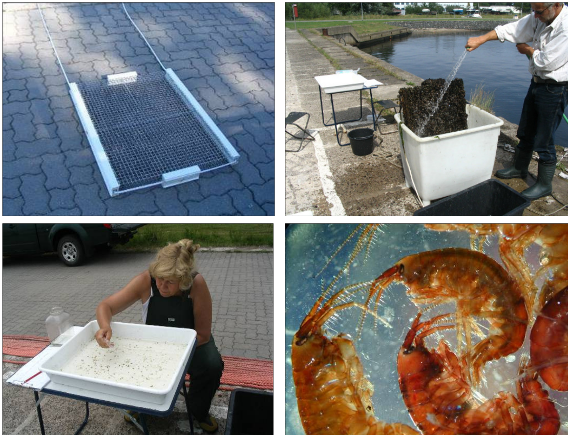
Abb. 1: Von links oben nach rechts unten – Doppelgittermetallrahmen vor der Auslagerung, Herausspülen der Kleinkrebse aus den bewachsenen Gittern, Aussortieren der Proben vor Ort und Blick durchs Binokular auf einen Kleinkrebs ( Gammarus salinus ), Fotos: bioplan
