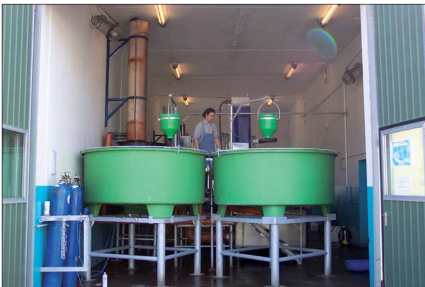
Bild 1: Blick in die Versuchsanlage Hohen Wangelin auf zwei Rundbecken (grün), die Kaskade (rot) und den Tauchtropfkörper/Biofilter (blau)
