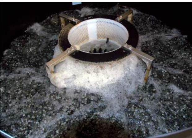
**Abb. 6:** Blick in einen Moving-Bed-Filter
